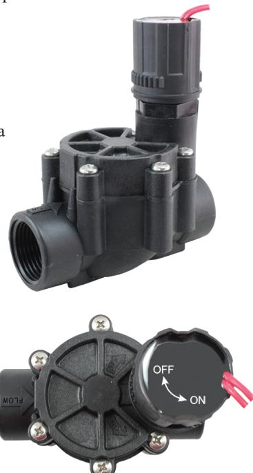
При отсутствии питания открытие клапана производится вручную поворотом катушки на 90° по стрелке ON, закрытие клапана – поворотом по стрелке OFF.
